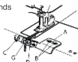
4. Platzieren Sie den Stoff unter dem Nähfuß und nähen Sie ihn mit dem Gummiband zusammen. (Nähen Sie ein Probestück, bevor Sie den eigentlichen Stoff nähen.)
