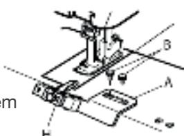
2. Schieben Sie die Klammer (C) nach links und lösen Sie die Halterung (D).
