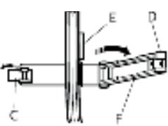
2. Presione el cierre (C) hacia la izquierda y libere la placa de sujeción (D).
